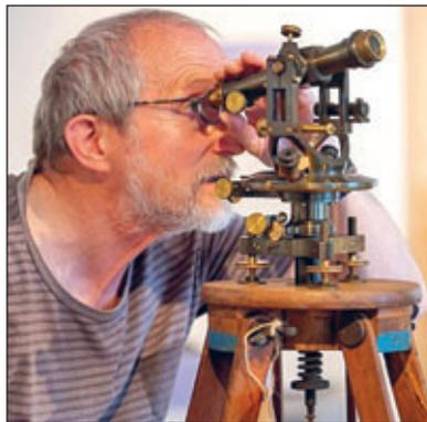
Demonstration einer Vermessung mit Theodolit, Quelle: Ausstellung in Großenhain
